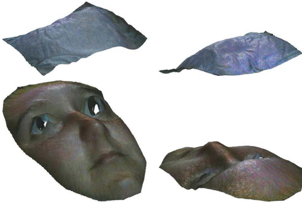
Figure 6: Résultat de la reconstruction 3D à partir du dispositif multimédia, appliquée aux deux séries de 4 images couleur de la figure 4. Le dispositif permet de retrouver à la fois les coordonnées 3D des points de la surface photographiée, et l'albédo relativement à chacun des canaux de couleur. Le dispositif multimédia utilisé est un ordinateur personnel HP EliteBook 8570w avec caméra HD 1280 \times 720 .
